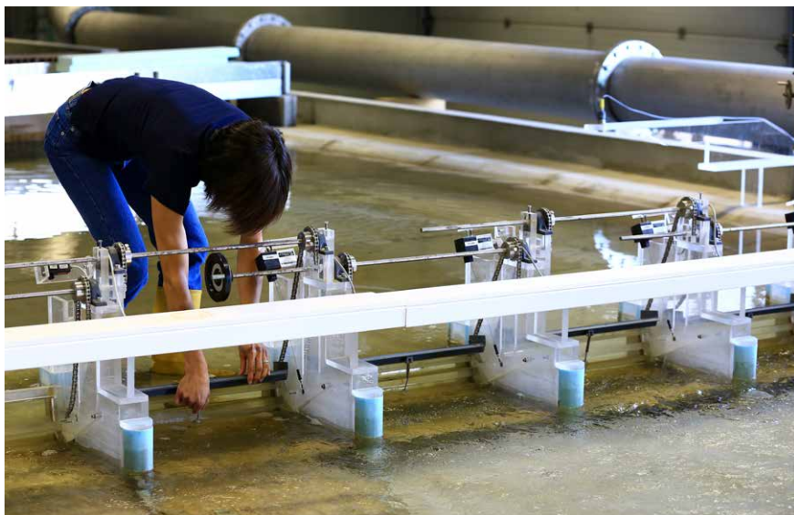
Étude sur modèle physique pour comprendre les phénomènes d'érosion aval du barrage de Donzère
