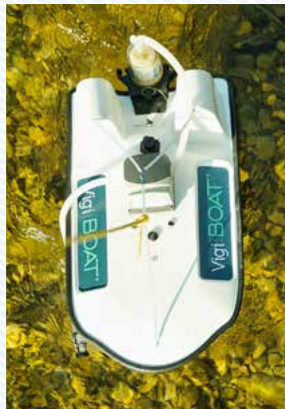
Les « mini-bateaux préleveurs » de CNR pompent et filtrent l'eau afin de capturer l'ADN.
